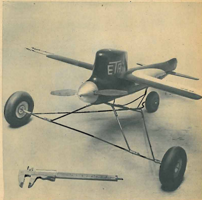
Sopra: Un modello da velocità telecomandato mediante due fili d'acciaio (visibili le estremità di questi uscenti dall'ala). Il modello è stato costruito dal Sig. Carlo Sauderla di Milano. Sotto: Lo stesso modello smontato - come si vede la fusoliera è composta di due gusci uno dei quali porta il motore. Il carrello, al lato, si sfilava dall'aereo quando questo decollava per liberarlo da un peso e da una resistenza all'aria che ne frenerebbe la velocità. Questo modello è simile al «Levriero» da noi pubblicato nel numero di Maggio, ed ha raggiunto nelle prove la velocità di 275 Km. orari.
