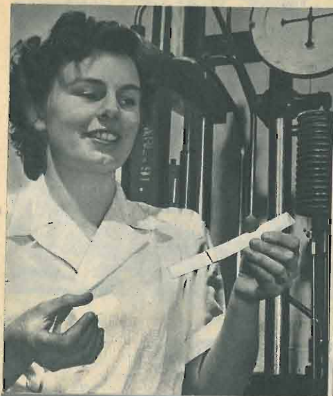
Sopra: In laboratorio - due strisce di metallo incollate con « Redux », sono state sottoposte ad uno sforzo di 1200 Kg.: la giunzione è rimasta intatta. A destra: Il dott. C. Mylonas usa il polariscopio per studiare il comportamento dell'adesivo.
